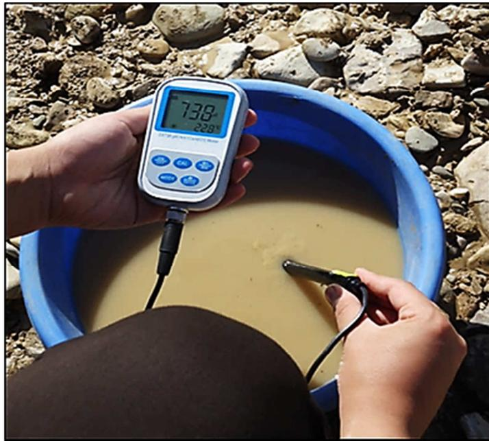
**Figure 34** : un appareil multiparamétrique de terrain modèle HANNA.
