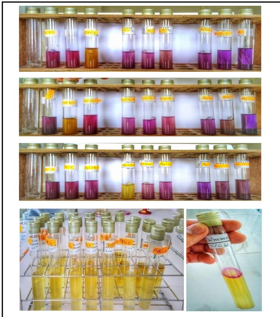
**Figure 38 : Résultats de dénombrement des coliformes**
