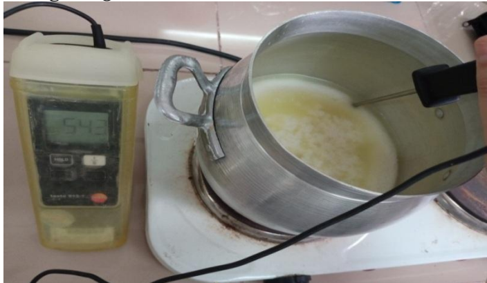
3- Mesure de la température maximale du chauffage
