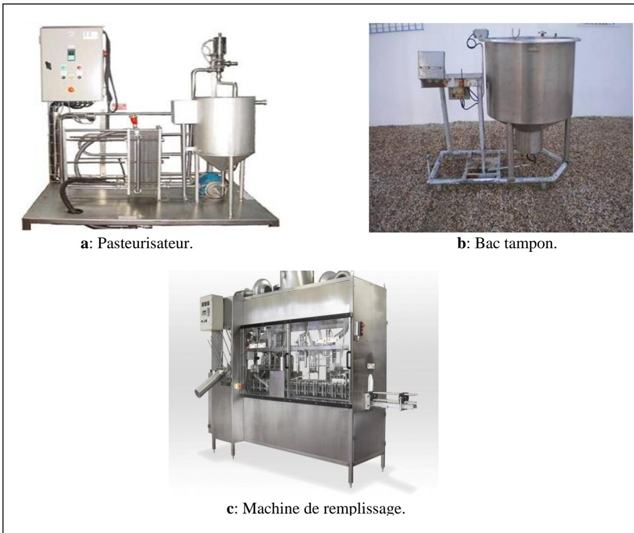
**Figure 1** : Equipements de la ligne du traitement du lait [5].
