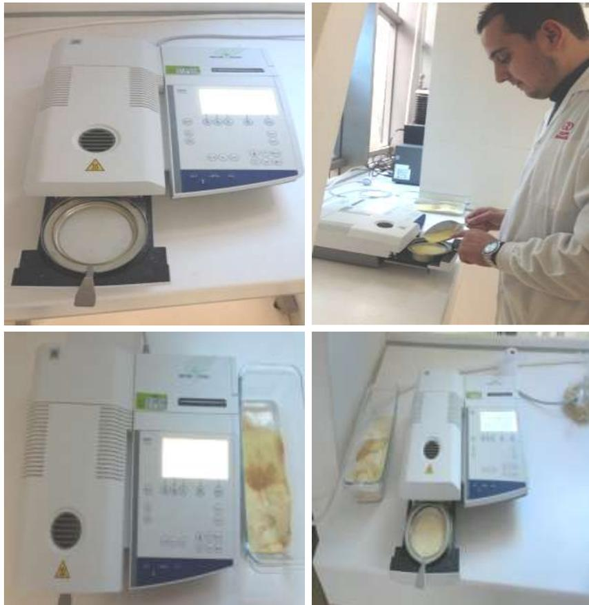
Figure 6 : Dessiccateur halogène pour déterminer l'humidité
