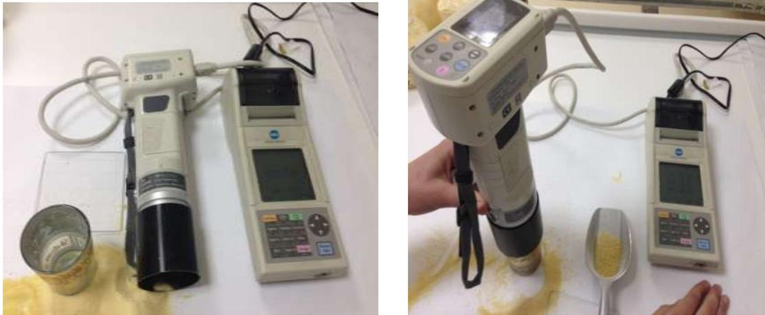
**Figure 5 : Colorimètre avec calculateur pour mesurer la couleur**
