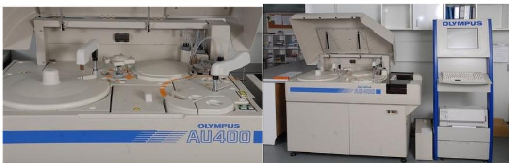
**Photo 10 :** Automate : Turbidimètre.
