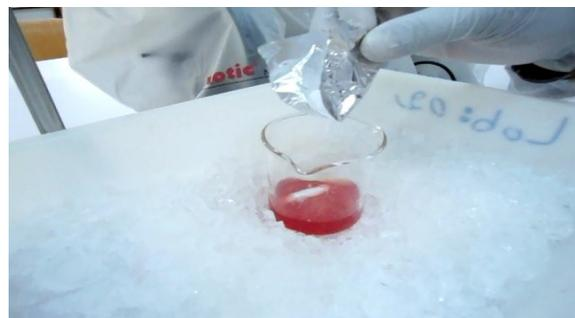
**Photo 5:** Ajout du sulfate d'ammonium
