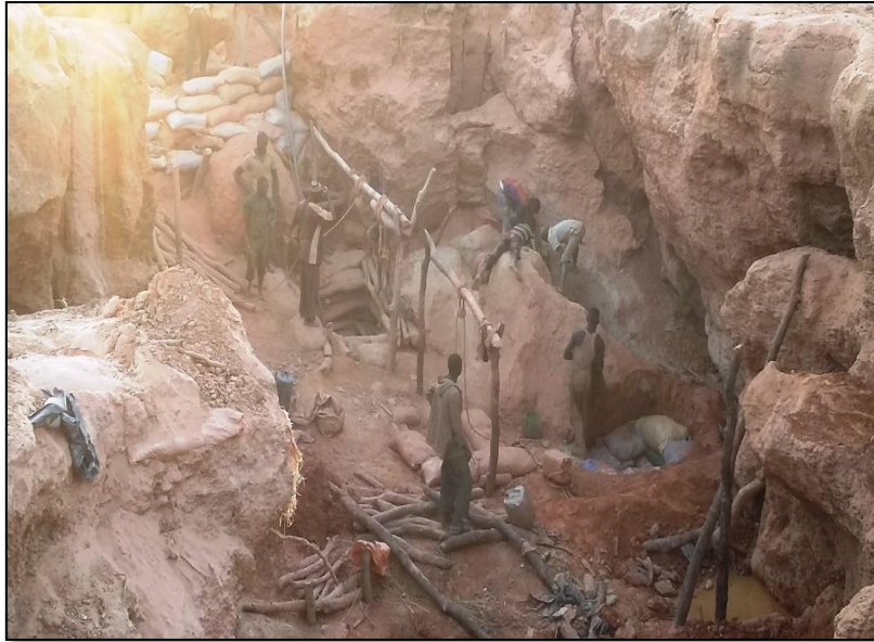
Illustration 3: Fonçage et extraction du minerai. (Site de Farabacoura, 2016 ; Photo personnelle).
