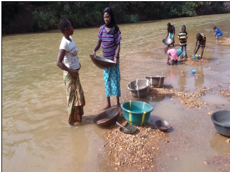
Illustration 5: Traitement par batée du minerai au bord de la rivière. (Site de Massiogocoro, 2016 ; Photo personnelle).
