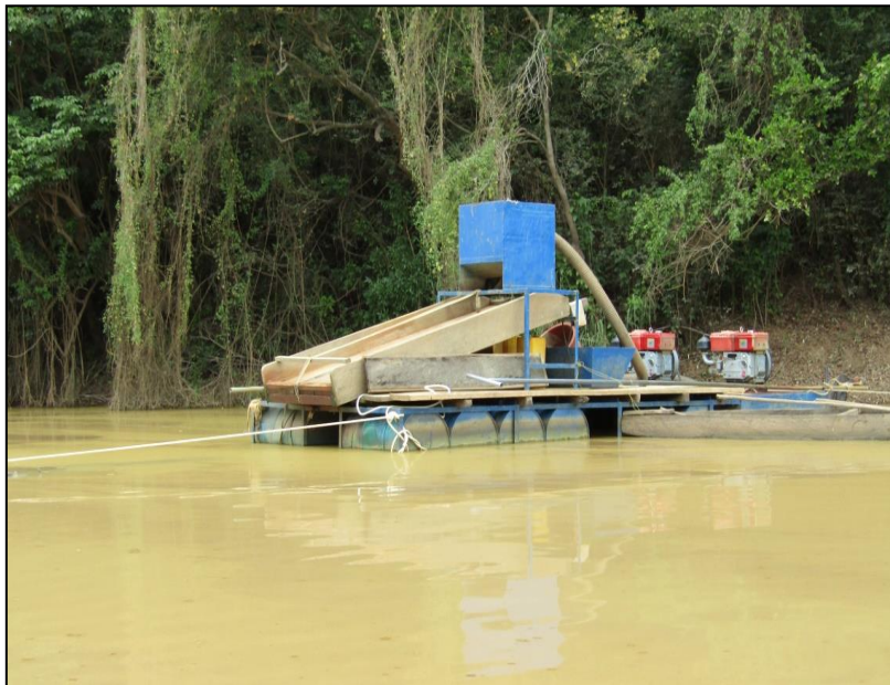
Illustration 4: Drague dans le lit de la rivière Bagoé. (Site de Massiogocoura, 2017 ; Photo personnelle).
