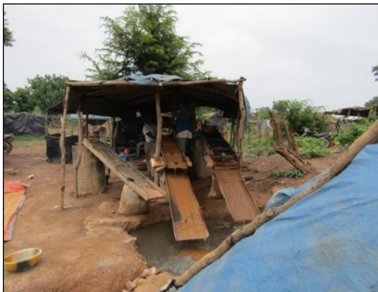
Illustration 8: Lavage à l'écluse du minerai.
