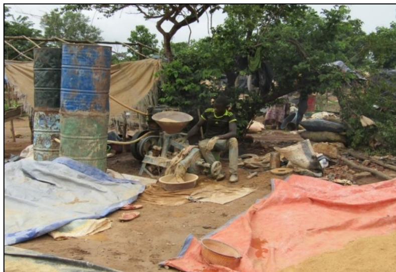
Illustration 7: Broyage au moulin du minerai en poudre fine. (Site de Kalako, 2016 ; Photo personnelle).
