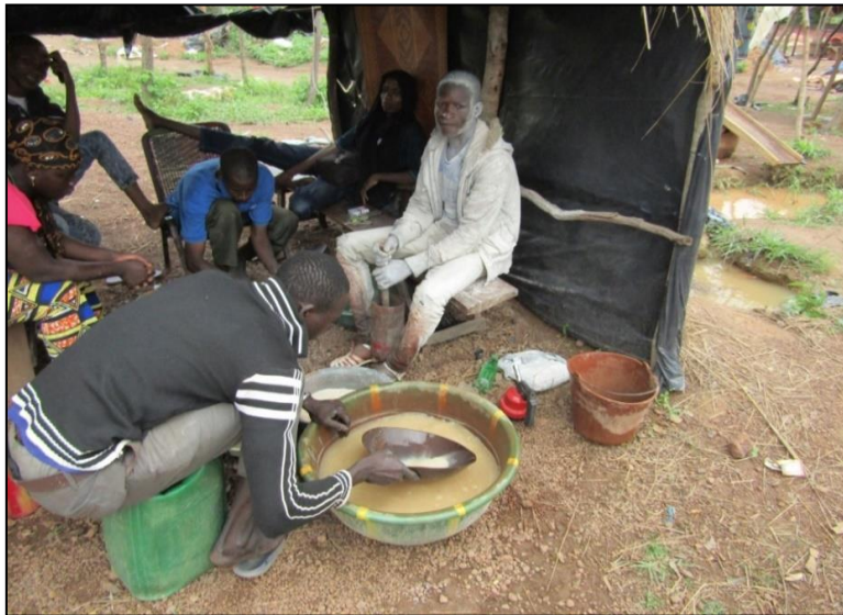
Illustration 6: Concassage et test de la teneur du minerai en or (site de Kalako, 2016).
